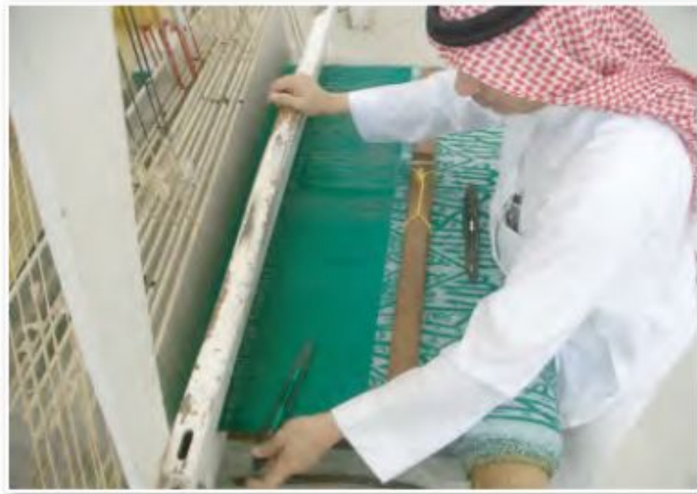
الشكل (٦٠): نلاحظ كيف يمرر النسيج المكوك.
