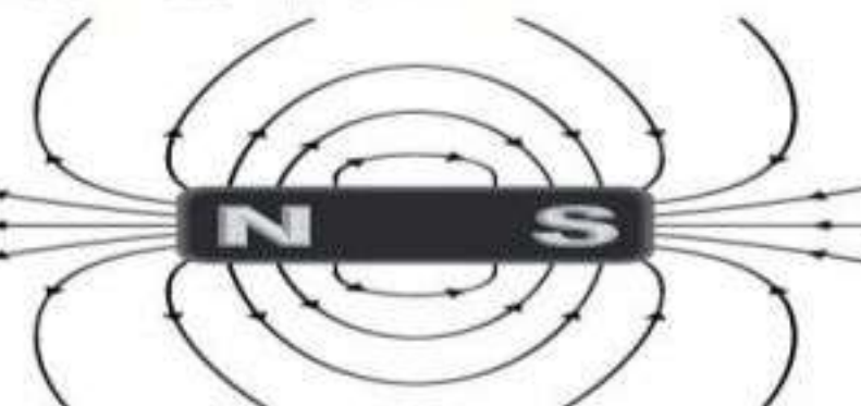
تساعد برادة الحديد على إظهار خطوط المجال المغناطيسي حول قضيب مغناطيسي .
