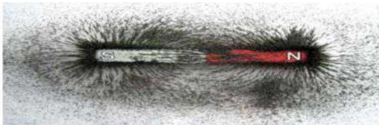
تساعد برادة الحديد على إظهار خطوط المجال المغناطيسي حول قضيب مغناطيسي .
