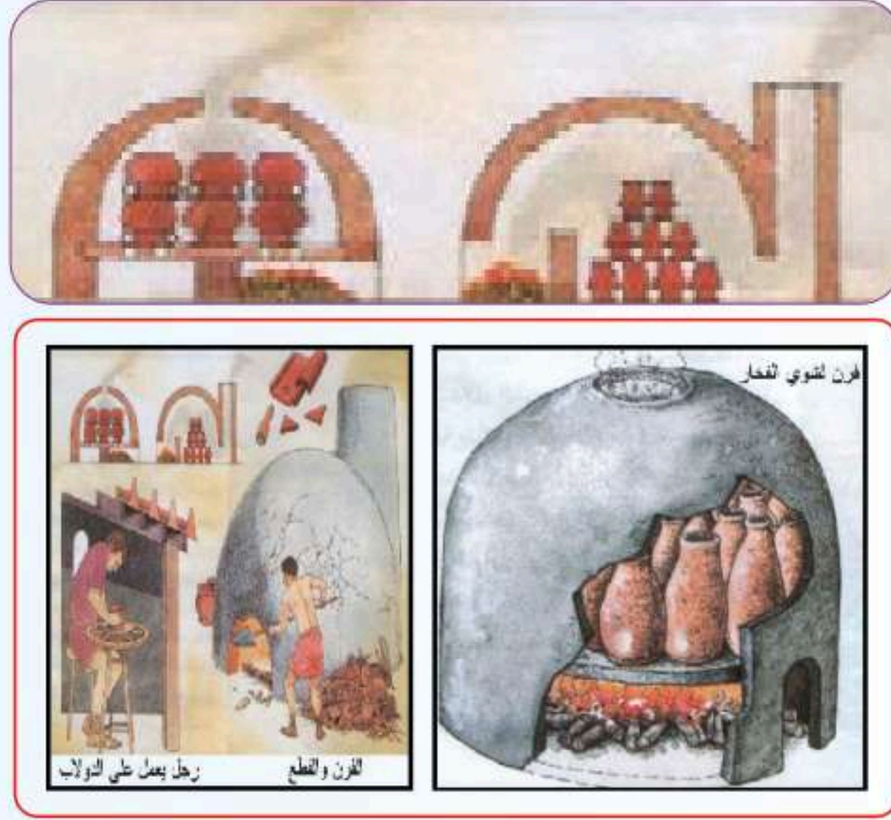
شكل (٦١ :ج) الطريقة البدائية الثالثة توضح شكل الفرن وطريقة رص الأعمال ومكان تغذية النار.
