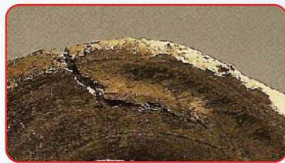
شكل (٥٢): يوضح نتائج أخطاء التجفيف (تشقق).
