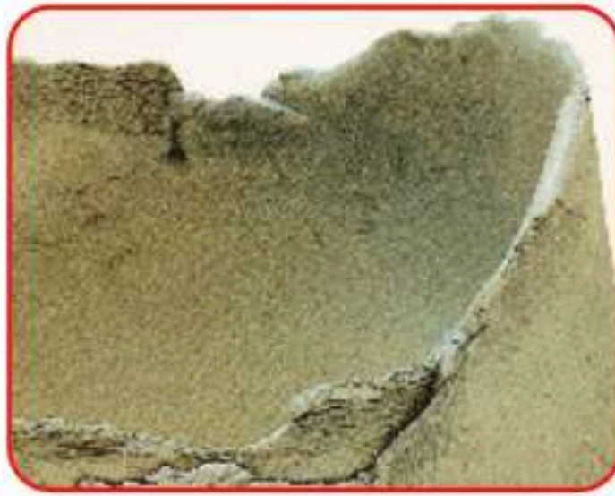
شكل (٥٢): يوضح نتائج أخطاء التجفيف (تشقق).
