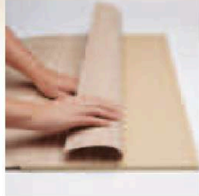
الشكل ( ٦٠ ) : تستخدم القشرة لتغطية الأسطح الخشبية على مساحات كبيرة .
