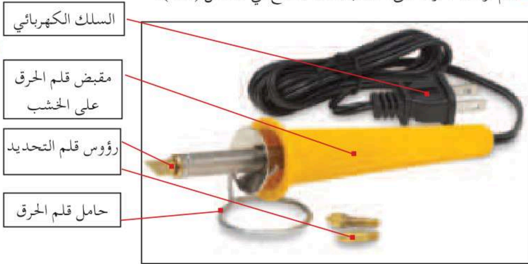
الشكل (٦٤): قلم أو أداة الحفر على الخشب.
