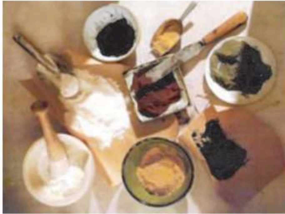
الشكل ( ٦ ) : بعض الأكاسيد الملونة بعد طحنها .
