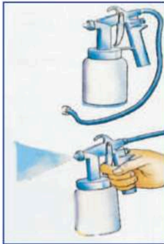
الشكل (١١) : بخاخة موصلة بمضخة .
