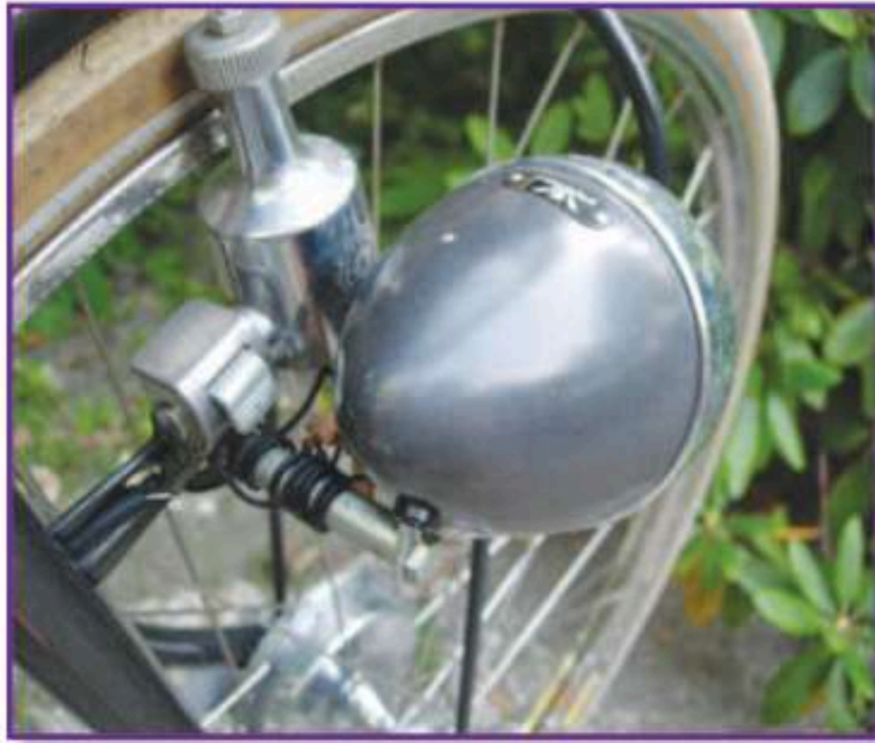
يتصل المولد الكهربائي بعجلة الدراجة
