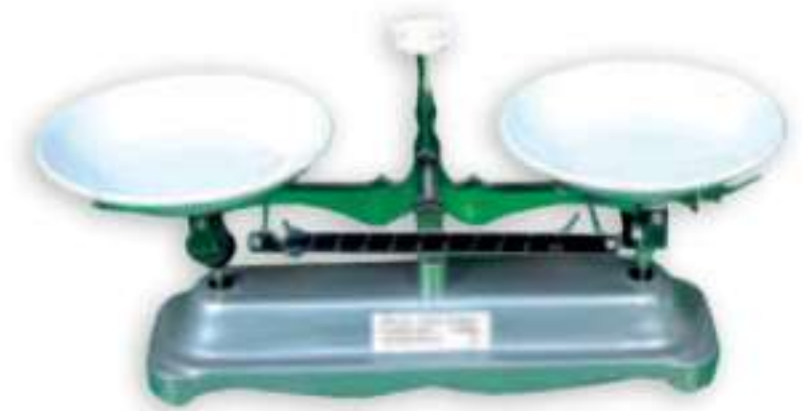
يستخدم الميزان ذو الكفتين لقياس الكتلة.
