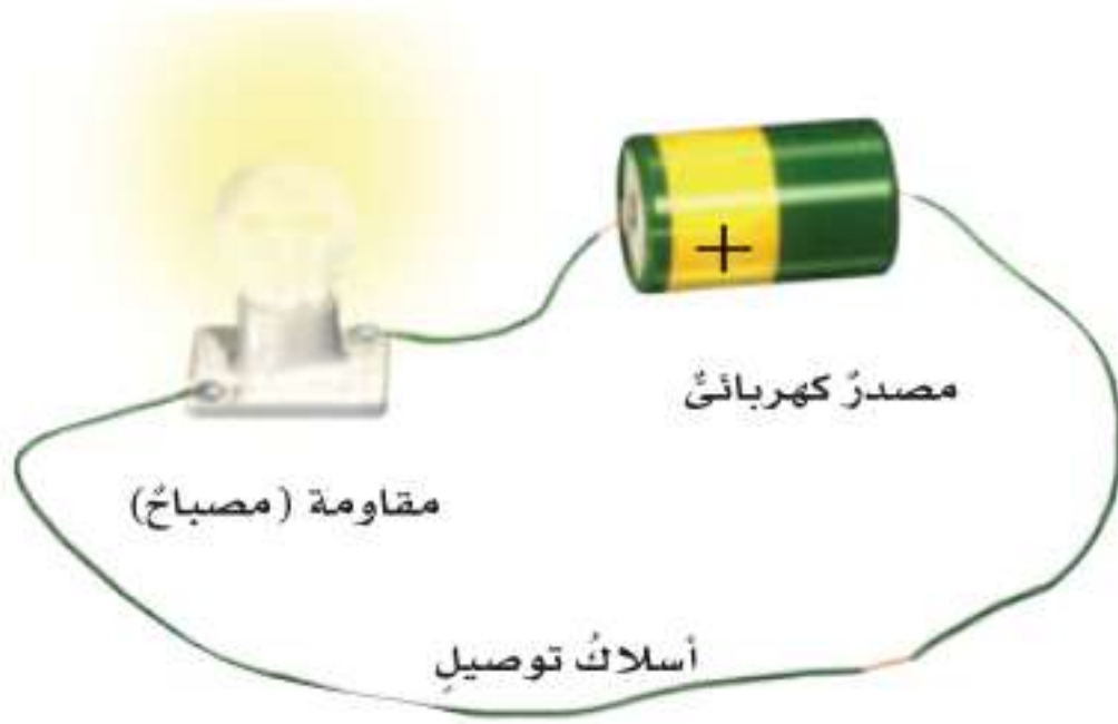
▲ أجزاء الدائرة الكهربائية.
