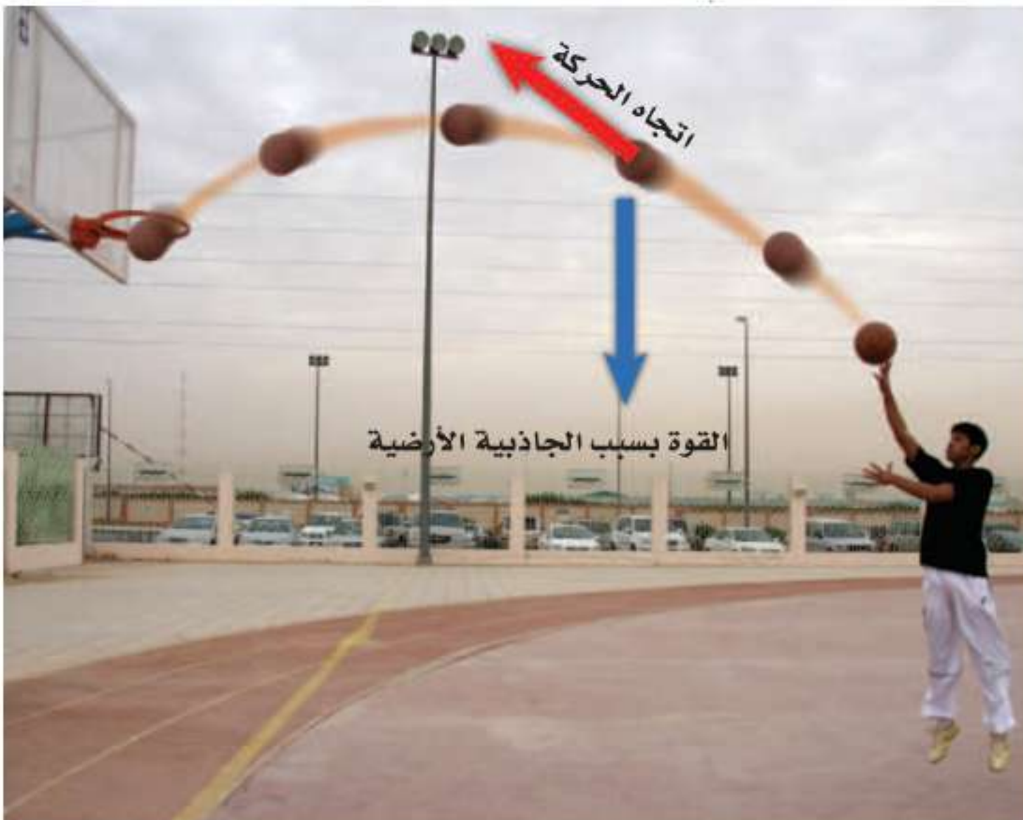
الشكل ١٠ تؤثر الجاذبية في الكرة بقوة تصنع زاوية مع سرعتها المتجهة، مما يجعل مسارها منحنياً. توقع كيف تكون حركة الكرة إذا قُذفت في اتجاه أفقي؟
