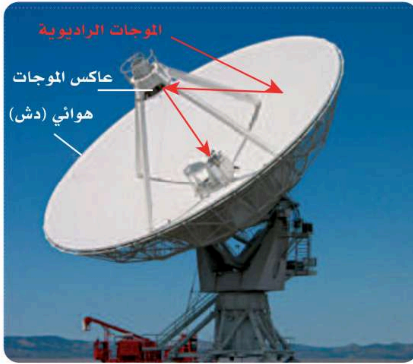
الشكل 14-3 تركيب المنظار الراديوي.
