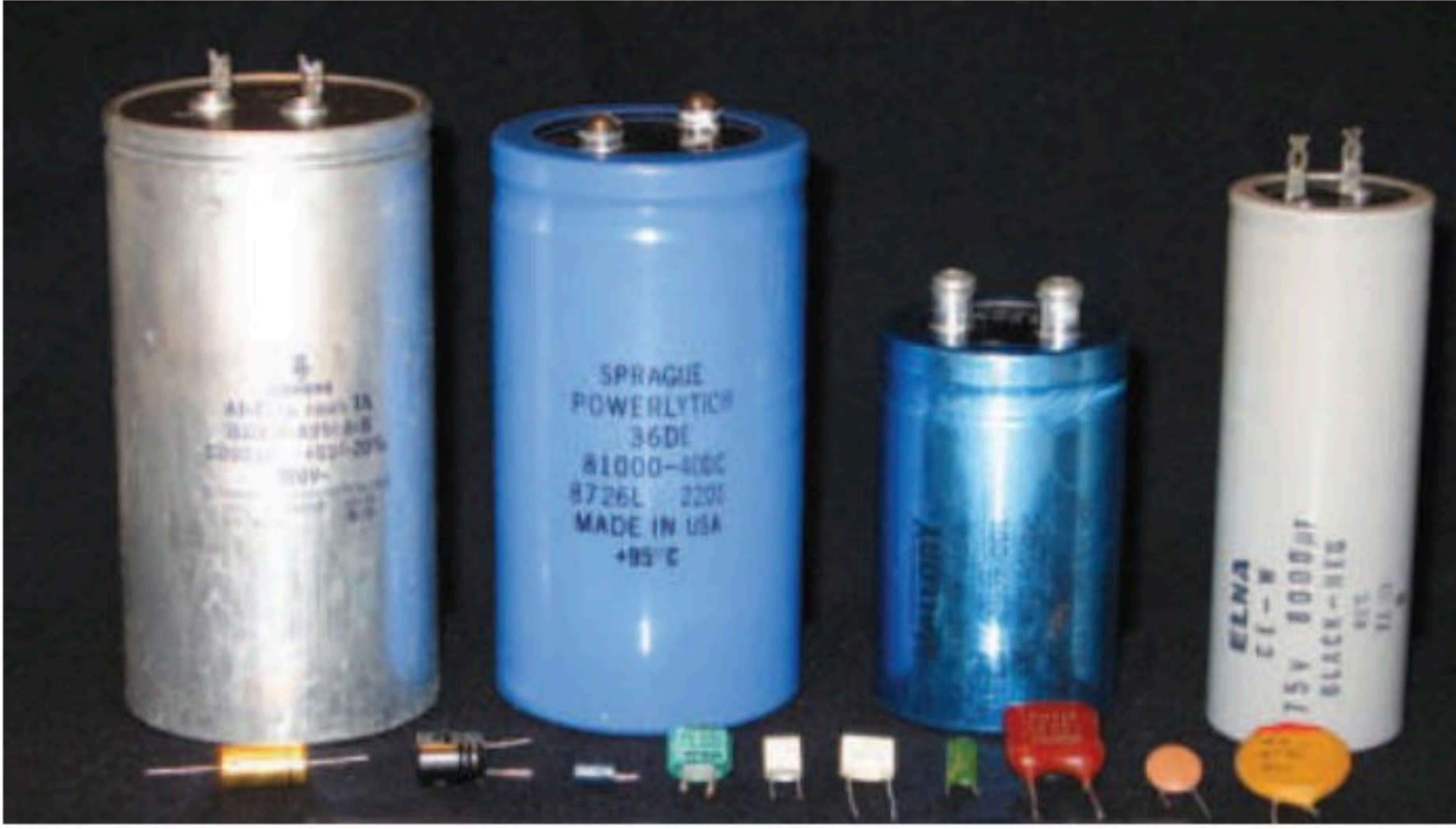
■ الشكل 15-3 تبين الصورة المجاورة أنواعًا مختلفة من المكثفات.
