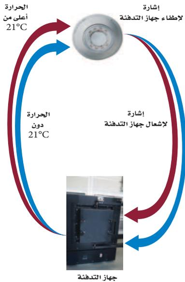
■ الشكل 14-4 ينظم نظام التدفئة المركزية أو يشتعل بناءً على العلاقة بين درجة الحرارة التي يتم رصدها ودرجة الحرارة المرجعية (التي تم ضبطها).
