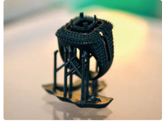
شكل 3.18: خاتم بوليمر ضوئي مطبوع باستخدام طباعة ثلاثية الأبعاد
