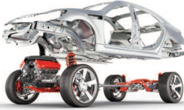
شكل 2.21: عرض تفصيلي لتجميع سيارة
