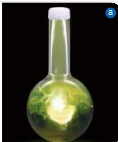
الشكل 4-4 يُنتج كل من هذين التفاعلين الكيميائيين طاقة كبيرة في أثناء تكوين المركبات الأيونية a. ينتج عن التفاعل بين عنصر الصوديوم وغاز الكلور بلورات صلبة بيضاء اللون. b. ينتج عن اشتعال شريط فلز الماغنسيوم في الهواء مركب أيوني يسمى أكسيد الماغنسيوم.
