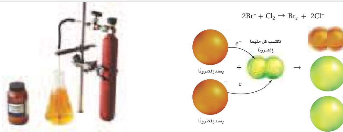
الشكل 3-2 التفاعل بين محلول أيونات البروميد وغاز الكلور هو تفاعل أكسدة، هنا تنتقل الإلكترونات من أيونات البروم إلى الكلور.
