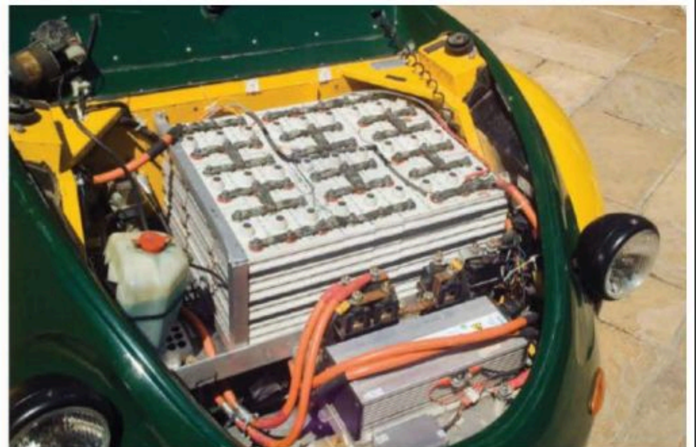
تزود بطاريات الليثيوم سيارة التجربة هذه بطاقة تجعلها تسير بسرعة قصوى مقدارها 113 km/h قبل أن يعاد شحنها . كما أنها تستطيع السير مسافة 320 km
