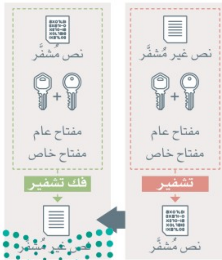
شكل 3.5: عملية التشفير باستخدام المفتاح غير المتماثل
