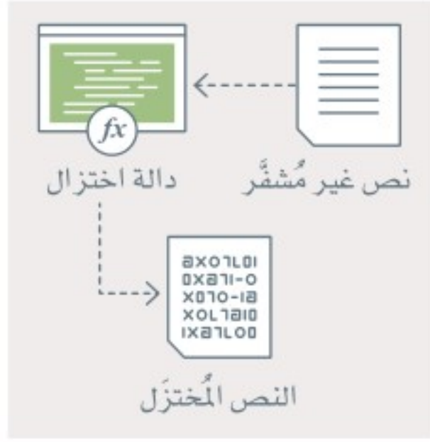
شكل 3.6: عملية التشفير باستخدام دوال الاختزال
