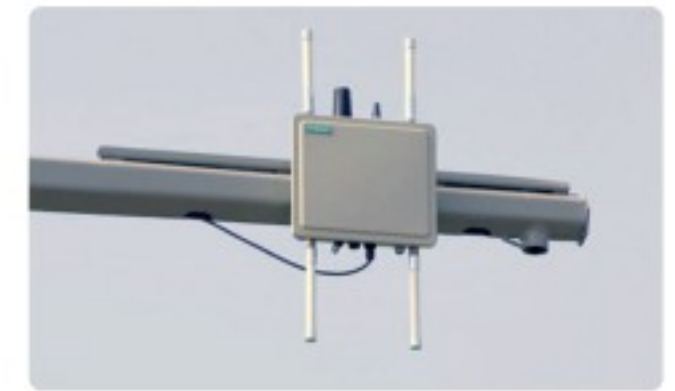
شكل 7.6: وحدة على جانب الطريق (RSU)
