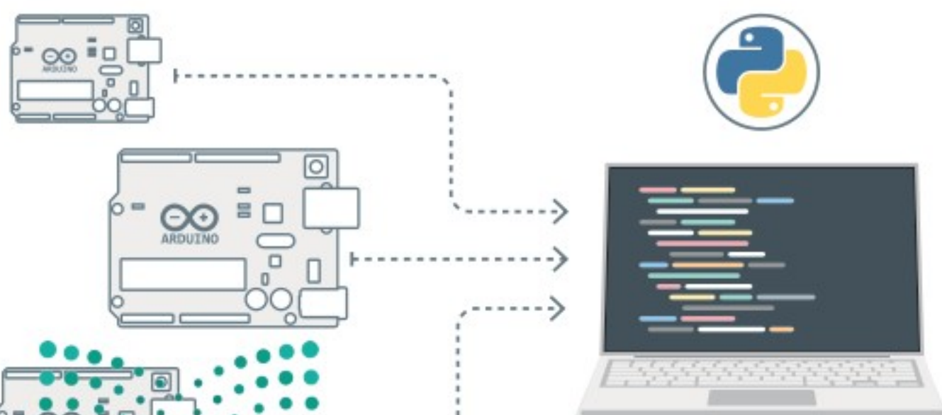
شكل 7.22: يُمثل برنامج بايثون دور مُستقبل MQTT
