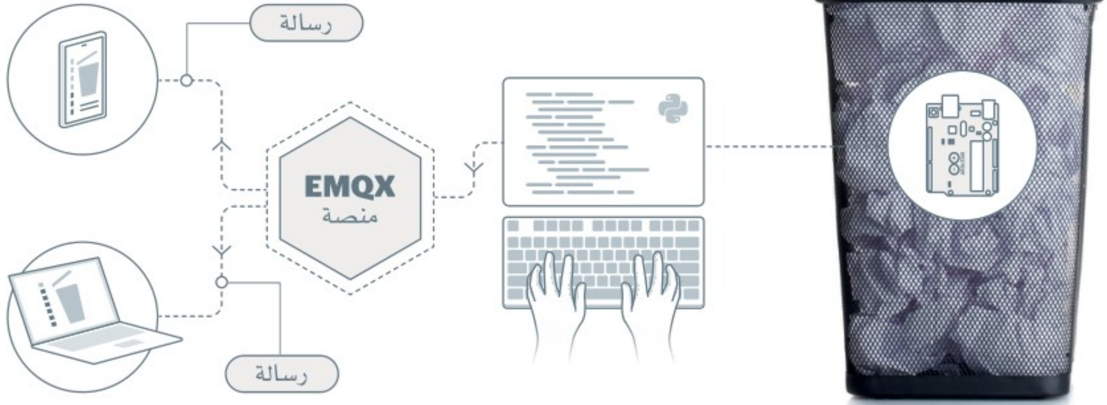
شكل 7.8: مشروع إدارة النفايات الذكية بالأردوينو وبروتوكول MQTT
