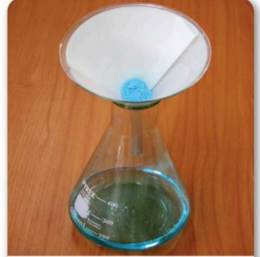
الشكل 2-13 عندما يمر المخلوط عبر ورقة الترشيح تبقى المادة الصلبة في الورقة، في حين يتجمع السائل المتبقي في الكأس.
