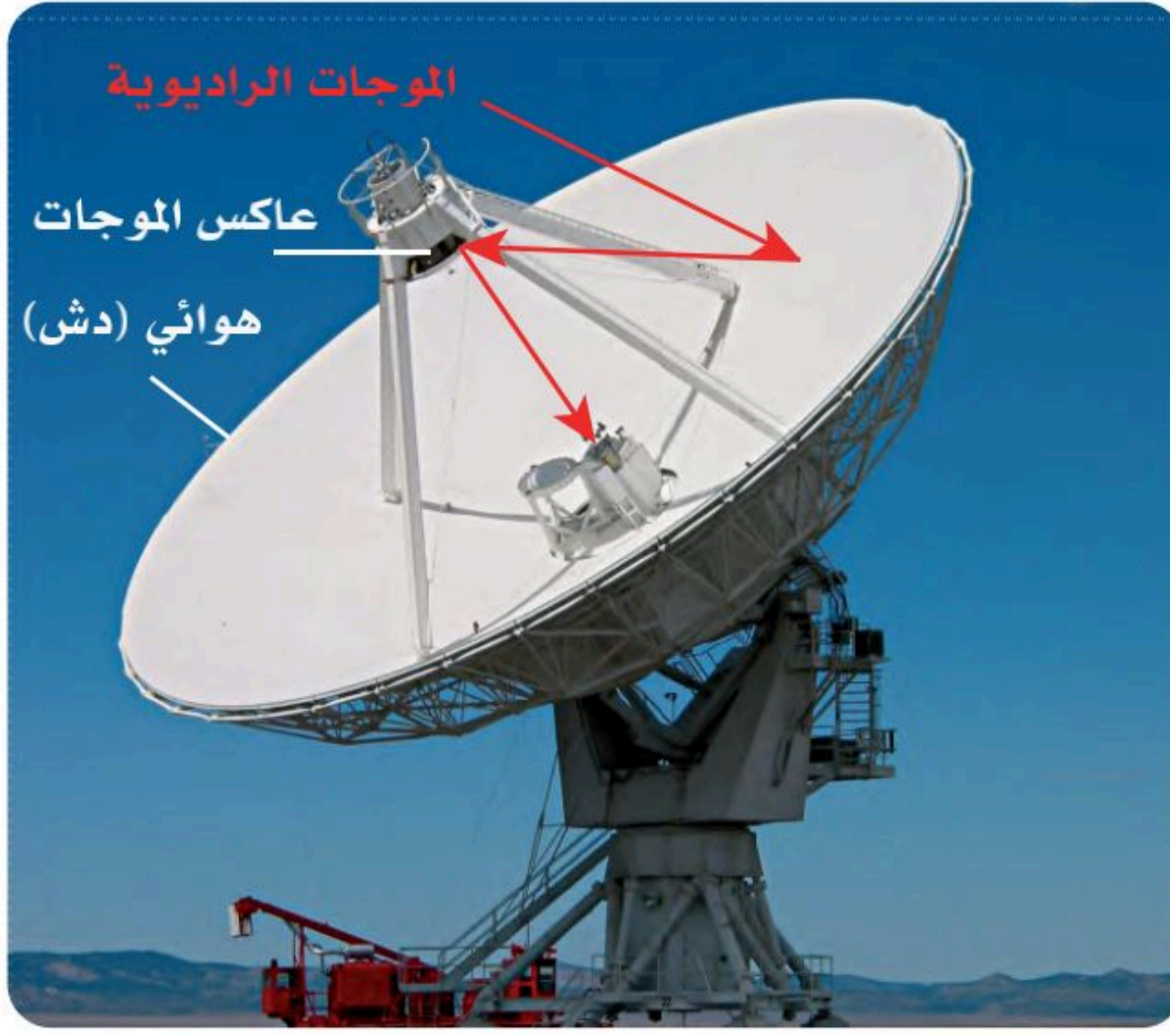
الشكل 14-3 تركيب المنظار الراديوي.
