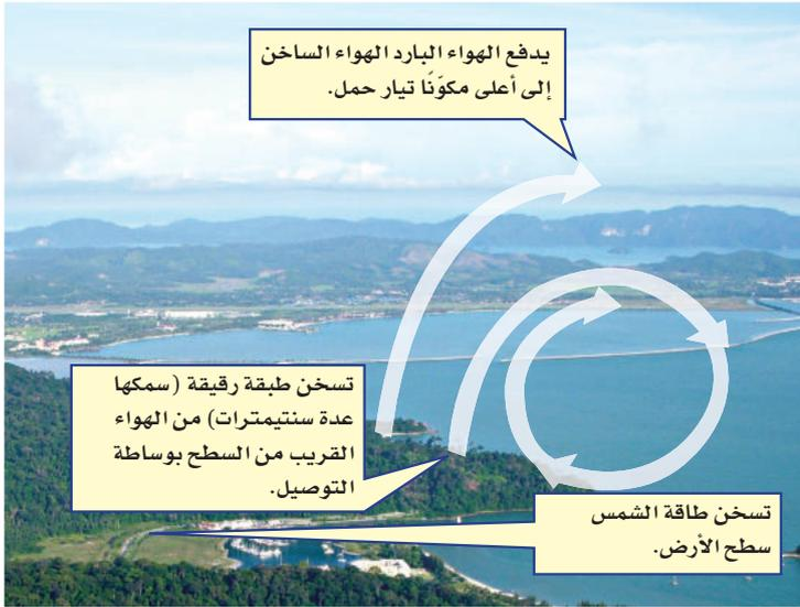
**نقل الطاقة** تسخن طاقة الشمس سطح الأرض، فتقوم جزيئات الهواء المتحركة بسرعة عالية بنقل الطاقة إلى الجزيئات البطيئة الحركة عندما تصطدم بها، وتسمى عملية نقل الطاقة نتيجة الاصطدام (التوصيل) ومن خلال عملية التوصيل تنتقل الحرارة من سطح الأرض إلى الهواء الملاصق له فيسخن وتقل كثافته ويرتفع للأعلى فيبرد بالتدرج إلى أن تزداد كثافته فينزل إلى أسفل، وتسمى عملية صعود الهواء الساخن وهبوط الهواء البارد (الحمل)، وهي الطريقة الرئيسة التي تنتقل بها الحرارة في الغلاف الجوي، (انظر الشكل ٦).
