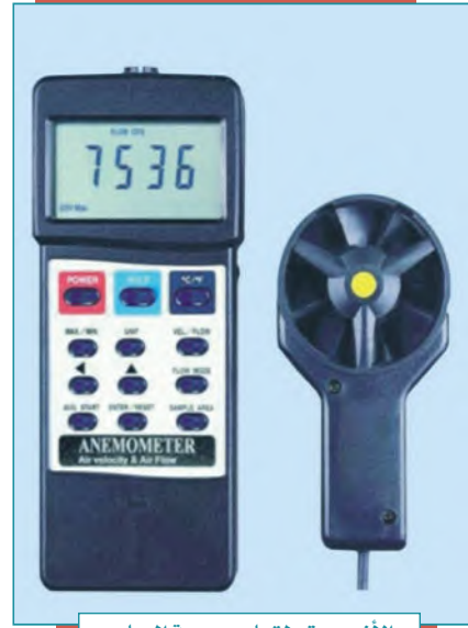
الأنيمومتر لقياس سرعة الرياح
