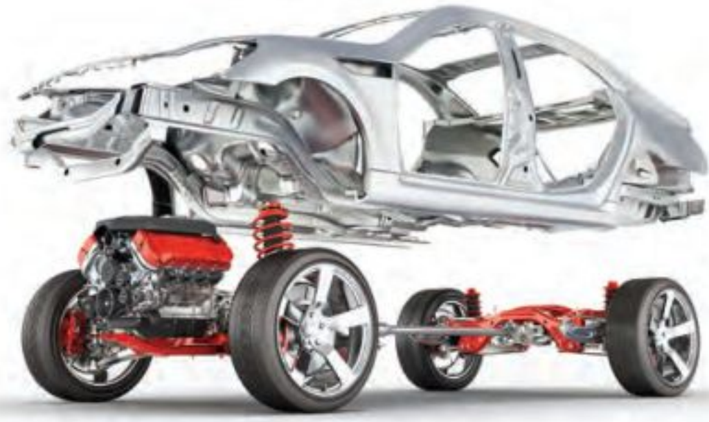
شكل 2.21: عرض تفصيلي لتجميع سيارة
