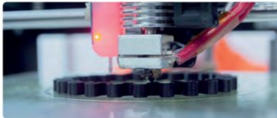
شكل 2.23: طباعة ثلاثية الأبعاد لنموذج أولي باستخدام طباعة ثلاثية الأبعاد
