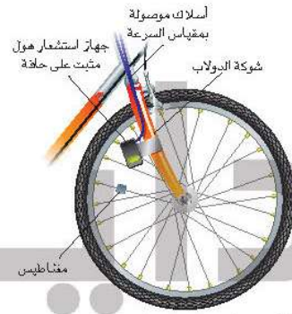
يستخدم المجس الذي يعمل وفق تأثير هول في مقياس سرعة الدراجة الهوائية لقياس سرعتها.
