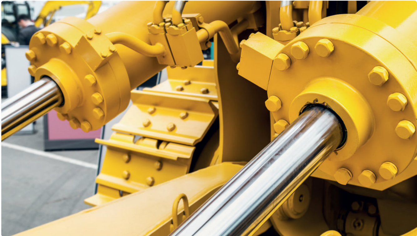
شكل 1.15: نظام مُشغل هيدروليكي (مكبس) لآلات الثقيلة
