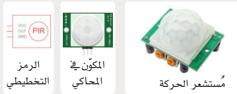
شكل 3.5: مُستشعر الحركة (PIR sensor)
