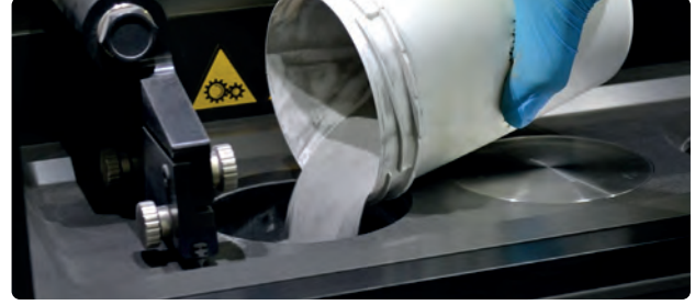
شكل 3.11: مسحوق الفولاذ المقاوم للصدأ للطباعة ثلاثية الأبعاد
